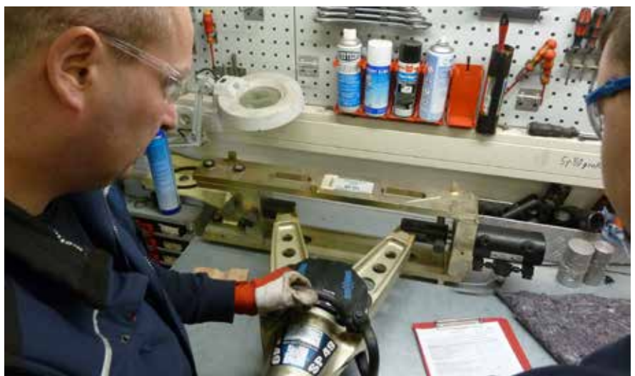
►► Prüfung eines hydraulischen Spreizers
